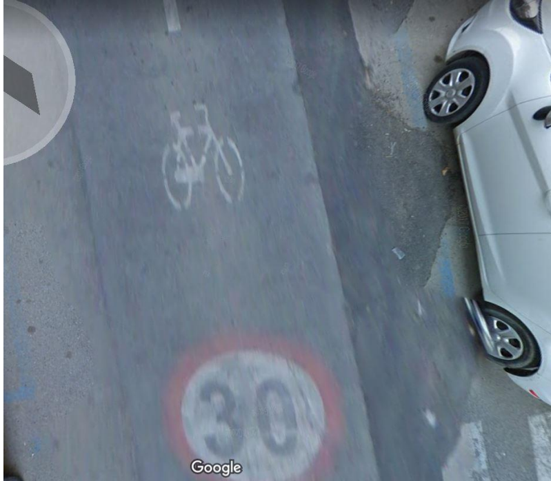
Segnaletica orizzontale – dopo soli pochi mesi non più visibile
